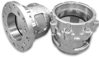
PROKOSCH-Schaugläser sind für den Einsatz mit pulverisierten und granulierten Medien, Gasen und neutralen Flüssigkeiten geeignet. Sie sind für den Einbau in ein Rohrleitungssystem mittels eines Gewindes oder Flanschen oder einer Kombination aus beidem vorgesehen. PROKOSCH-Schaugläser sind ohne Spezialwerkzeug leicht zu warten und lassen sich durch den modularen Aufbau leicht an unterschiedliche Installationsanforderungen anpassen.
