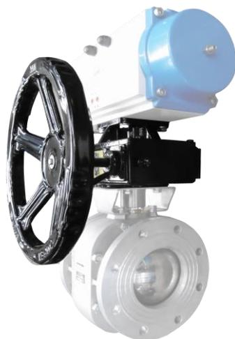
PROKontrol Handnotbetätigungsgetriebe werden für pneumatisch betätigte PROKOSCH Kugelhähne eingesetzt. Das Handnotgetriebe wird zwischen dem Ventil und dem Stellantrieb auf der Montagekonsole montiert.
