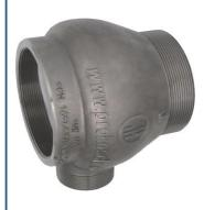
PROKOSCH Ringdüsen sind geeignet für pneumatische Förderung, zum Beschleunigen der Förderung von pulverisierten und granulierten Gütern. Einbau mittels Gewinde direkt in die Förderleitung bzw. wahlweise mittels Flansche oder einer Kombination von Flansch und Gewindeanschluss. Einbringung der Förderluft mittels eines nach oben, bzw. dem Medium entgegen-gerichteten Anschlussstutzen.
